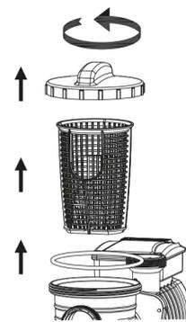
**ПРИМЕЧАНИЕ:** Защитный фильтр надо регулярно чистить. Грязный или забившийся защитный фильтр ухудшает работу песчаного фильтра.
